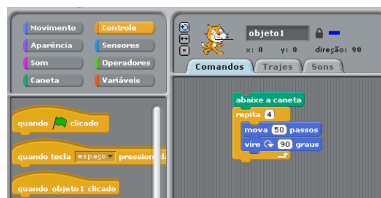
Figura 10: Construção de um quadrado usando repetição
